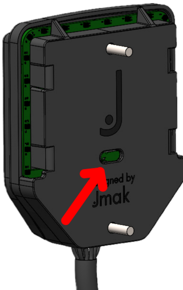
Figura 13: Conexão USB-C do J-M15.
